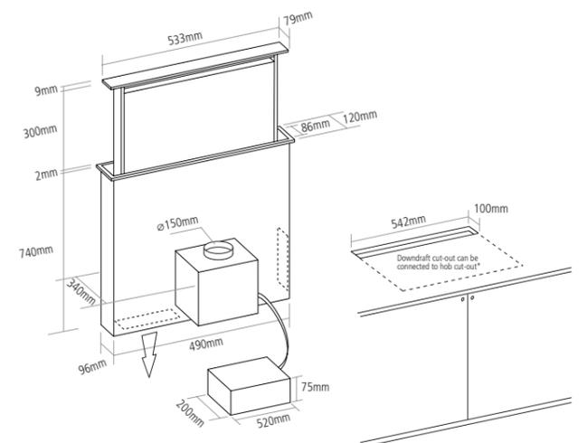
**\*FOR ELECTRIC HOBS ONLY. A 50MM GAP IS REQUIRED FOR GAS HOBS.**
